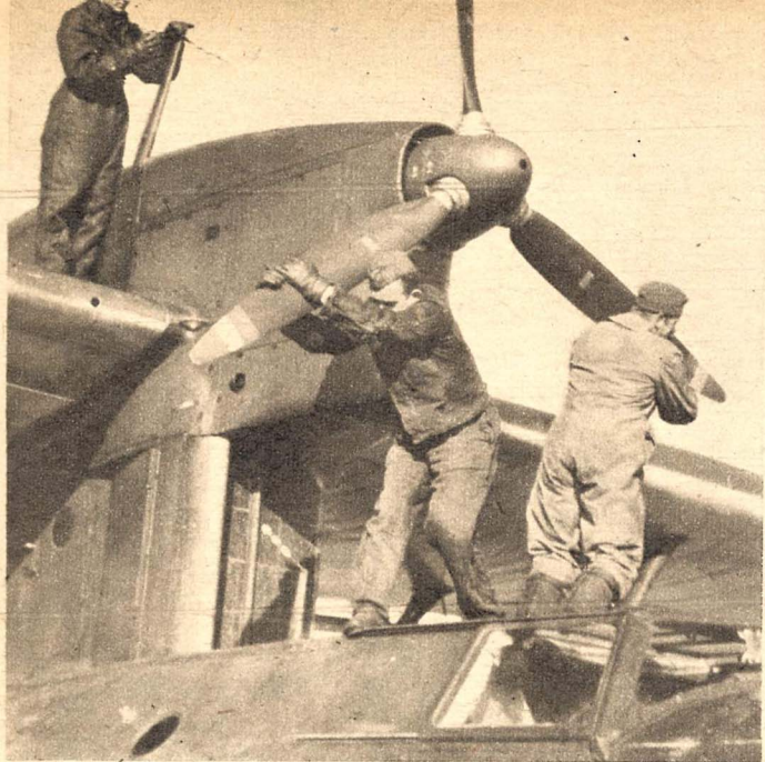
Unterdies lassen die Motorenwarte die Motoren anlaufen, während der Funkwart eine letzte Überprüfung der Antennenanlage vorimmt
