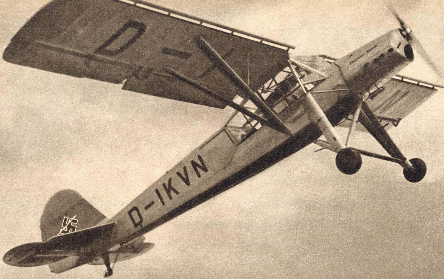
Der Fieseler „Storch“, das bewährte Langsamflugzeug der deutschen Luftwaffe, kurz nach dem Start, der in einem besonders steilen Winkel erfolgen kann
